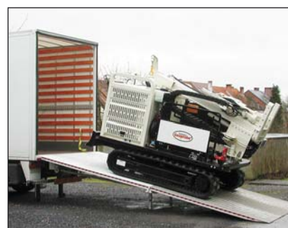
DH-AR2 3T - 5T - 9T - 16T Гидравлический пандус с двойной складной стальной платформой
