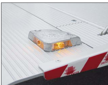
S090 Сигнальные фонари, смонтированные на платформе
