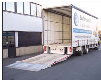
S239.LSU Раскладная платформа с усиленными шарнирными соединениями (под заказ - подлежит предварительному утверждению)
