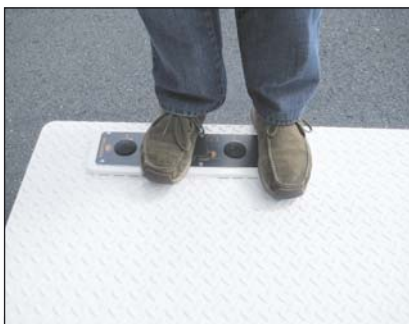
S006 4-кнопочное ножное управление, расположенное на платформе
