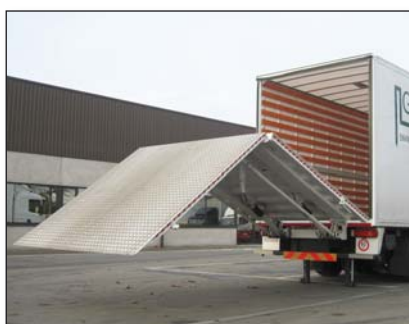
DH-AR2 3T - 5T - 9T - 16T Гидравлический пандус с двойной складной стальной платформой
