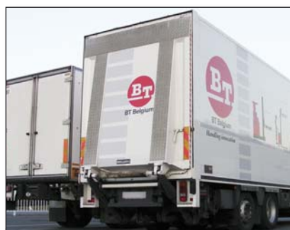
S201 Стальная платформа с плоской поверхностью между основными балками платформы
