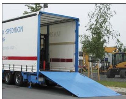
S408 Наклон платформы в положение пандуса
