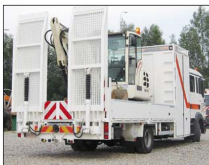
DH-AR 3T - 5T - 9T - 16T Гидравлический пандус с цельной стальной платформой
