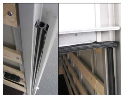
S600...603 Различные резиновые уплотнения для задней части кузова
