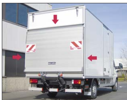
S275.H01 Алюминиевая платформа с горизонтальными профильными элементами S610 Платформа из анодированного алюминия
