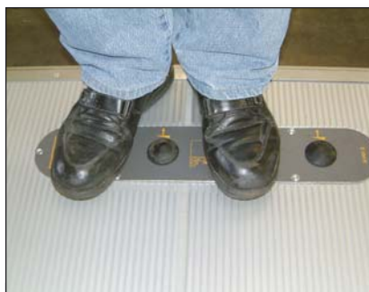
S006 4-кнопочное ножное управление, расположенное на платформе
