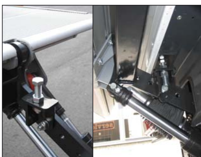
S412 Упор для подъемных рычагов гидроборта S424
