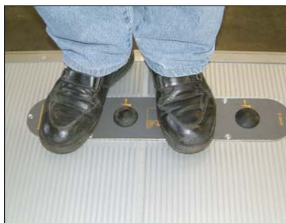
S006 4-кнопочное ножное управление, расположенное на платформе
