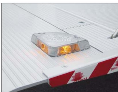
S090 Сигнальные фонари, смонтированные на платформе
