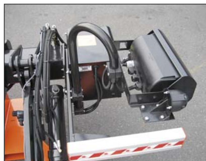
S411.LM Регулируемый монтажный кронштейн для блока управления
