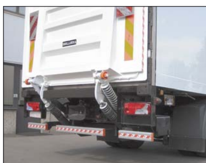
S362 Отбойник, состоящий из трех частей (секций) установленный на несущую балку гидроборта
