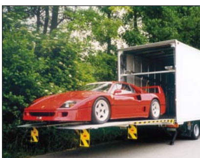
DH-EA 2500 кг - для перевозки легковых автомобилей с платформами длиной до 4500 мм
