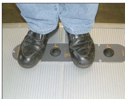
S006 4-кнопочное ножное управление, вмонтированное в платформу
