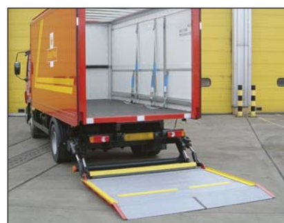
DH-LK 1250 кг - Стандартный гидроборт с плоской платформой (аналогичная используемой на колонных лифтах)
