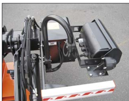
S411.LM Регулируемый монтажный кронштейн для блока управления
