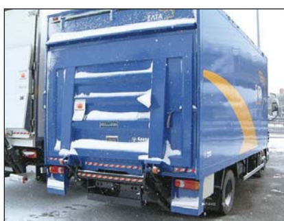
S400 Вариант DH-LMP для установки на шасси с очень коротким свесом
