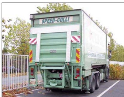
S400 Вариант DH-LMP для установки на шасси с очень коротким свесом
