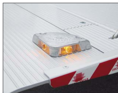
S090 Мерцающие сигнальные фонари, смонтированные на платформе
