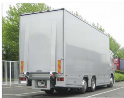
S202 Стальная платформа с полностью плоской наружной стороной
