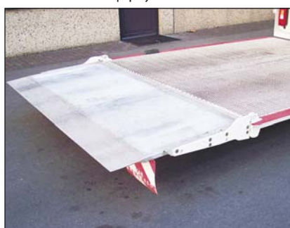
S239.LSU Складная платформа с усиленными шарнирным соединением
