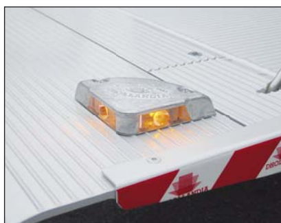
S090 Сигнальные фонари, смонтированные на платформе
