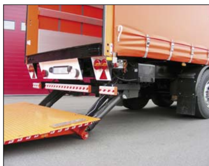
S362 3-х секционный отбойник, крепящийся несущей балке гидроборта
