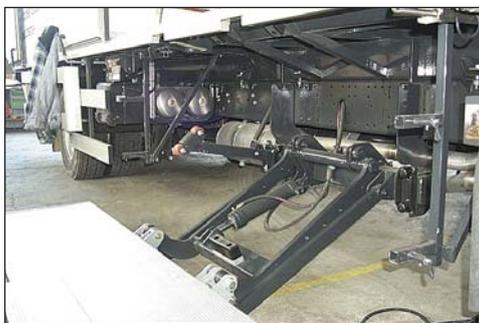
**DH-RC 750 кг** Крепится в боковой стене для загрузки / разгрузки через боковые двери транспортного средства
