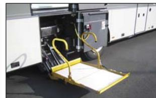
**DH-RB 500 кг** Подворачивающийся подъемник для более высоких уровней пола, т.е. для погрузки пассажиров / инвалидных колясок
