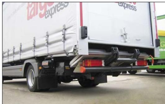
**DH-RC** 1000 кг - 1280 мм полностью алюминиевая платформа с круглым отбойным брусом (бампером), прикрепленным к подъемным рычагам
