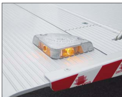
S090 Сигнальные фонари, смонтированные на платформе
