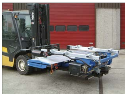
S410 Слайдер, полностью смонтированный на транспортном стеллаже быстрой установки
