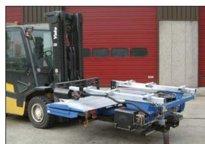
S410 Слайдер, полностью смонтированный на транспортном стеллаже быстрой установки
