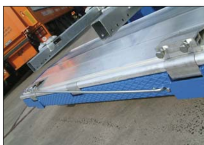
S258 Пружина скручивания на верхней части платформы
