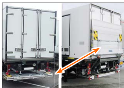
S244 Вертикальное сложенное положение сзади кузова транспортного средства
