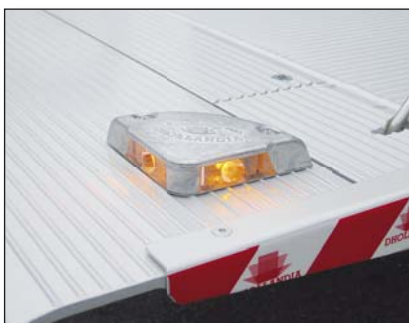
S090 Сигнальные фонари, смонтированные на платформе
